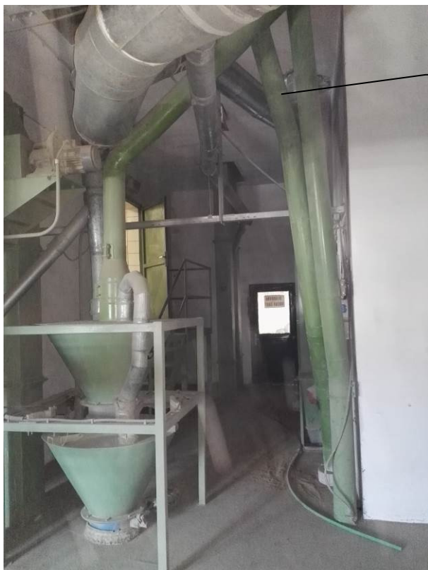
Obrázok: Existujúci stav spádových potrubí, nový žľabový závitovkový dopravník a usmerňovací prvok
